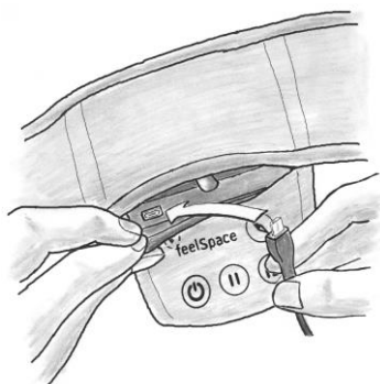
Figure 3 : Chargement de la ceinture à l'aide du chargeur fourni
